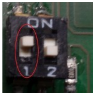
Switch 1 en position haute
